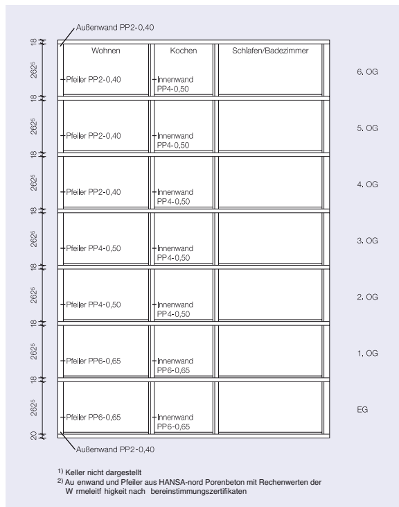
Bild 4.2: Schnitt A-A Mehrfamilienhaus [Maße in cm]
